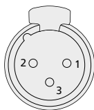
DMX-AUSGANG XLR-Montagestecker (Rückansicht)
